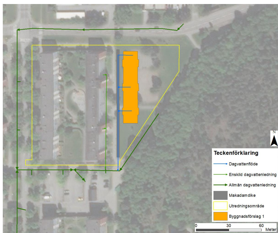
Figur 11. Flödesvägar för föreslaget avvattningsystem inom och runt utbredningsområdet. Vid uppförande av byggnadsförslag 2 anläggs ett liknande avvattningsystem.
